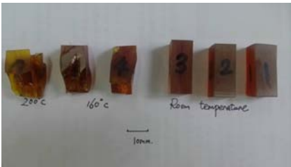
图 7 不同温度下树脂浇注体压缩破坏照片
